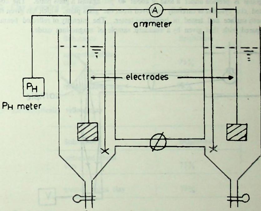
FIG 1 ELECTROLYTIC CELL
