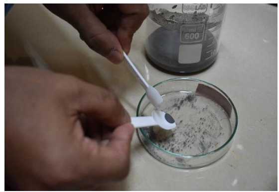
(d) The uppermost CFA layer (1 mm from the top) is scraping out
